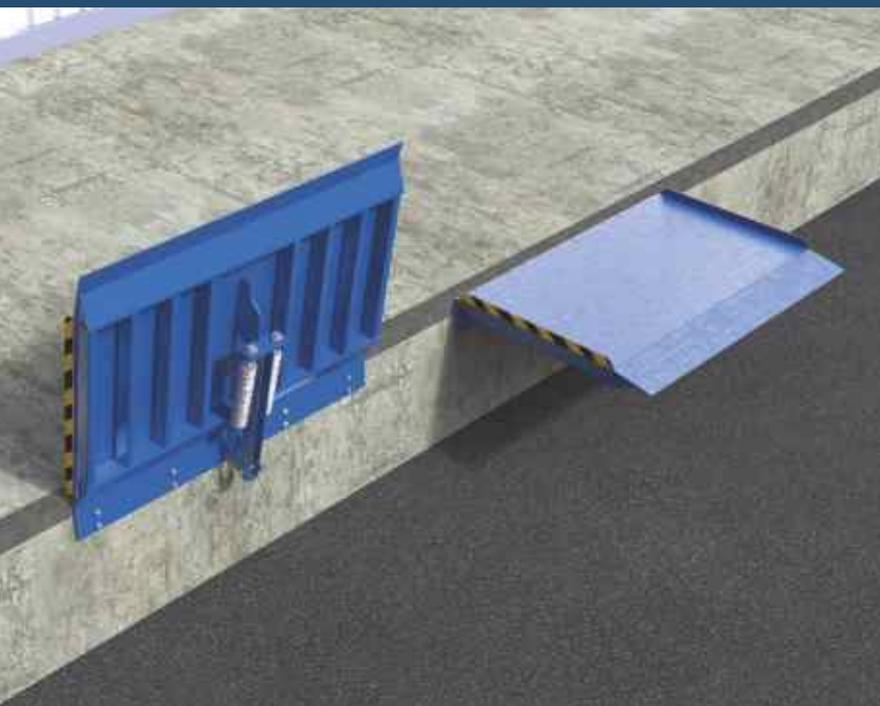
**Откидные мосты** предназначены для разгрузки ж/д вагонов или для разгрузки грузовых автомобилей, когда нет возможности припарковаться вплотную к пандусу. Откидные мосты устанавливаются на открытую рампу в стационарном или скользящем исполнении, компенсируя разницу между пандусом и кузовом грузовой платформы. Грузоподъемность откидных мостов STL – до 4 тонн.
